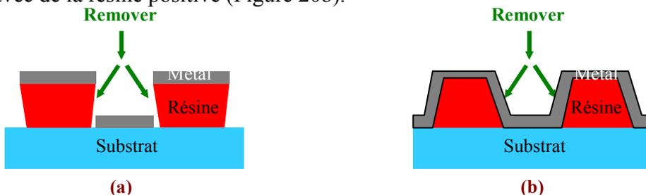
**Figure 20 : schéma représentant le dépôt métallique et l'action du Removeur sur les profils de : (a) la résine négative et (b) la résine positive**
