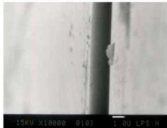
Photo M.E.B. n°4 : Coupe transversale de la résine positive déposée à 6000 tr/min
