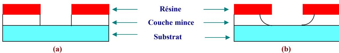
Figure 13 : Gravure anisotrope (a) et isotrope (b)
